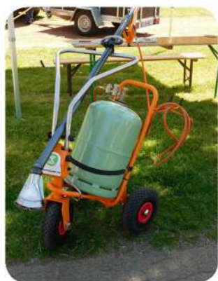
Déshebeur thermique à air chaud pulsé
